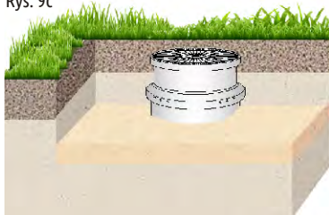
Rys. 9. Przykład poprawnego posadowienia studni z SK rozchodzącymi się poziomo w jednym rzędzie.
